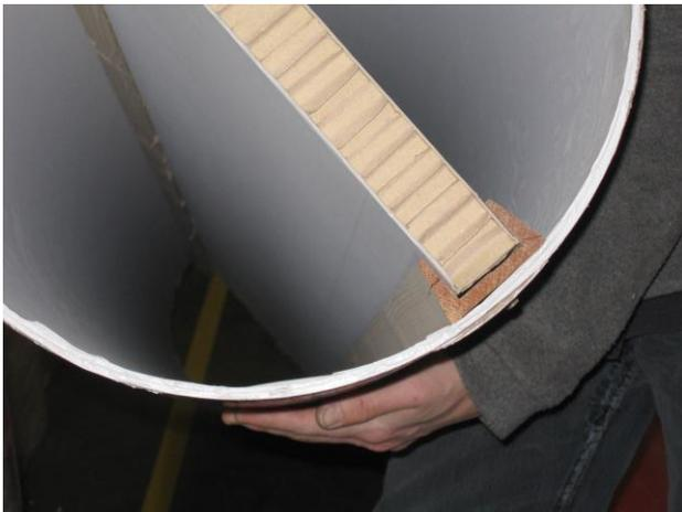
Le joint de dilatation est constitué d'une plaque d'Alu-plaque enchâssée dans un rail en bois et fixée sur la paroi du tube en carton.
